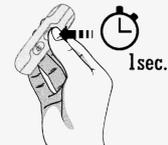
**Zum Einschalten**, drücken Sie die CALL-Taste 1 Sekunde lang. Alle LEDs leuchten auf. Das Gerät kann auch automatisch eingeschaltet werden, wenn es über einen magnetischen USB-Anschluss aufgeladen oder in die Docking-Station eingesetzt wird.
