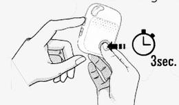
**Zum Ausschalten** des Geräts halten Sie die Seitentaste und die SOS-Taste gleichzeitig 3 Sekunden lang gedrückt, bis die LEDs erlöschen.
